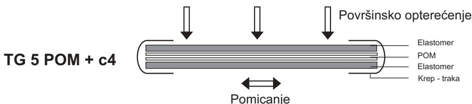
Kaširanja s elastomerom je neophodno kako bi se kompenzirale neravnine površine nalijeganja, kao i manja odstupanja od paralelnosti dodirnih površina.
