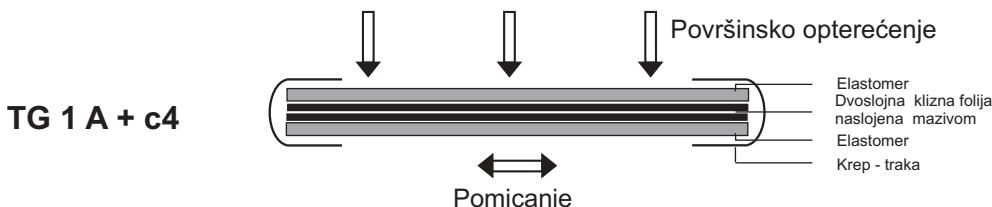
Kaširanje s elastomerom je potrebno, da se kompenziraju manje neravnine i neznatna odstupanje paralelnosti površine nalijeganja.
