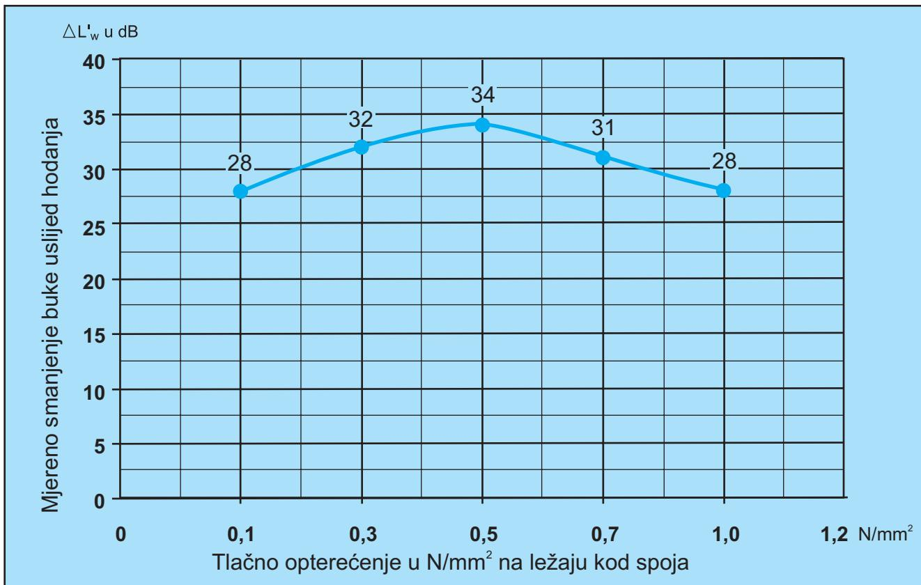
Leschugplast GLT SD rebrasti ležaj se može, temeljem izvanrednih svojstava, koristiti kod zvučnog izoliranja unutar širokog područja tlačnog opterećenja od 0,1 N/mm<sup>2</sup> do 1,0 N/mm<sup>2</sup>. Postignuta su izračunata smanjenja buke uslijed hodanja od najmanje 28 dB. Kod optimalnog izlaganja na tlačno opterećenje u iznosu od 0,5 N/mm<sup>2</sup> postiže se mjereno smanjenje buke uslijed hodanja od 38 dB.
