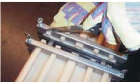
III. Umetnite vruæusjekiricu-nož između profila i pritisnite tako dugo dok se od rastopljene plastike ne formira kuglica promjera 5mm. Zatim izvadite sjekiricu-nož.
